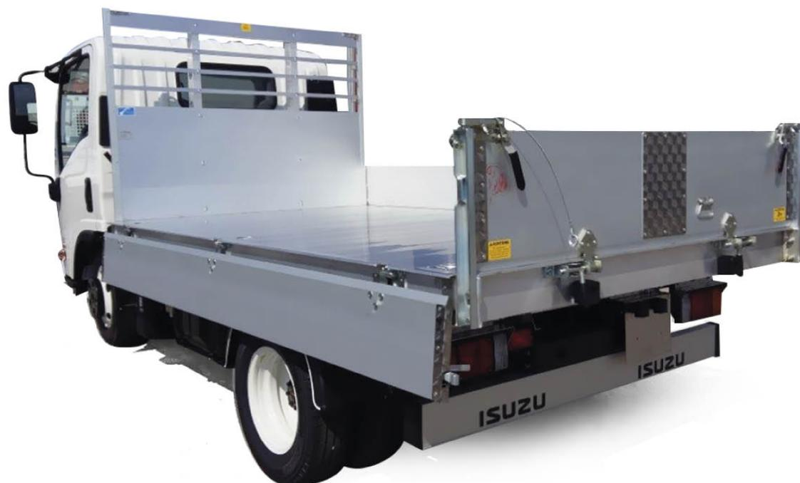
**Tribenne en aluminium avec coffre AR cabine H. 900 mm**
