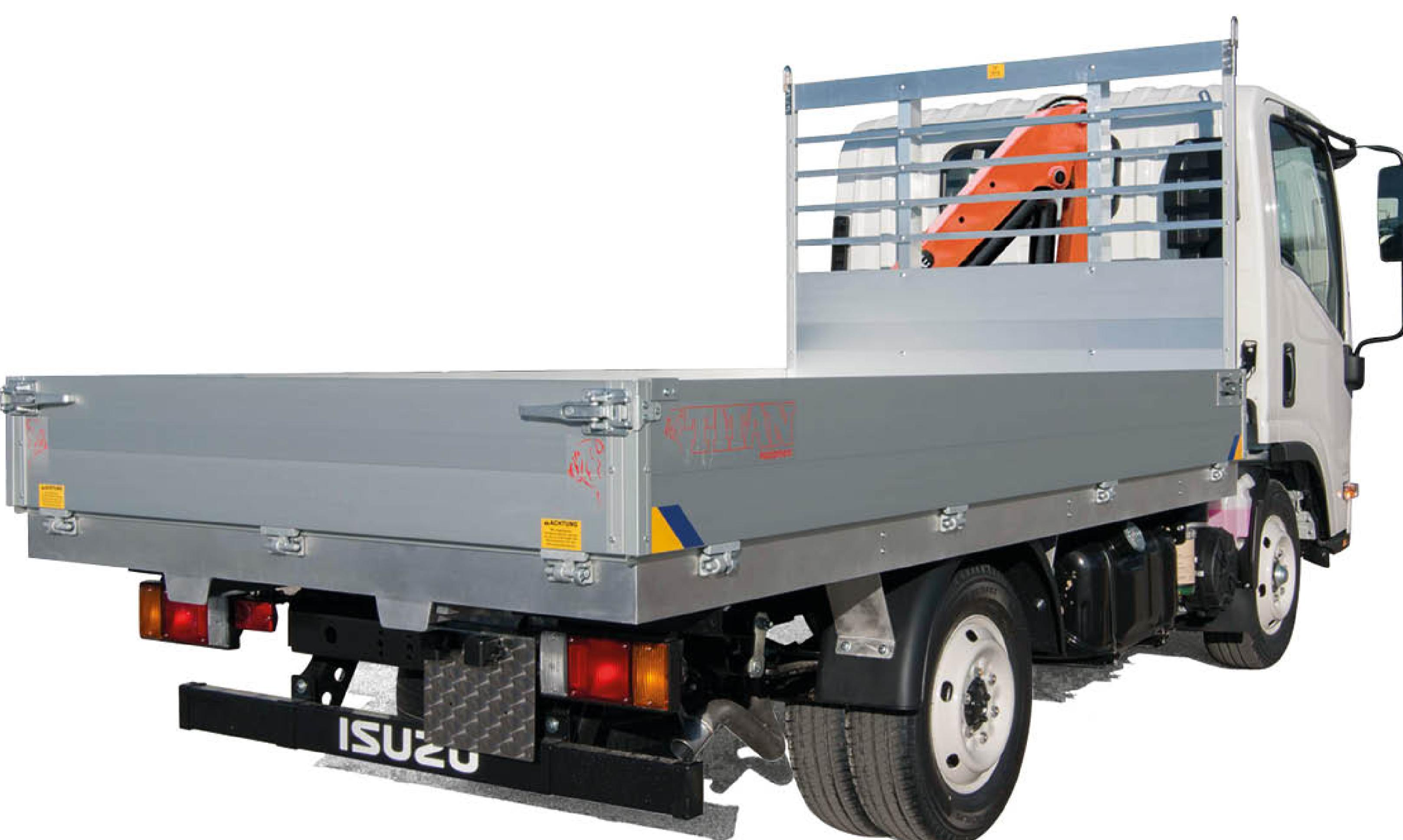
Struttura del piano di carico in alluminio liscio a doghe da 30 mm
