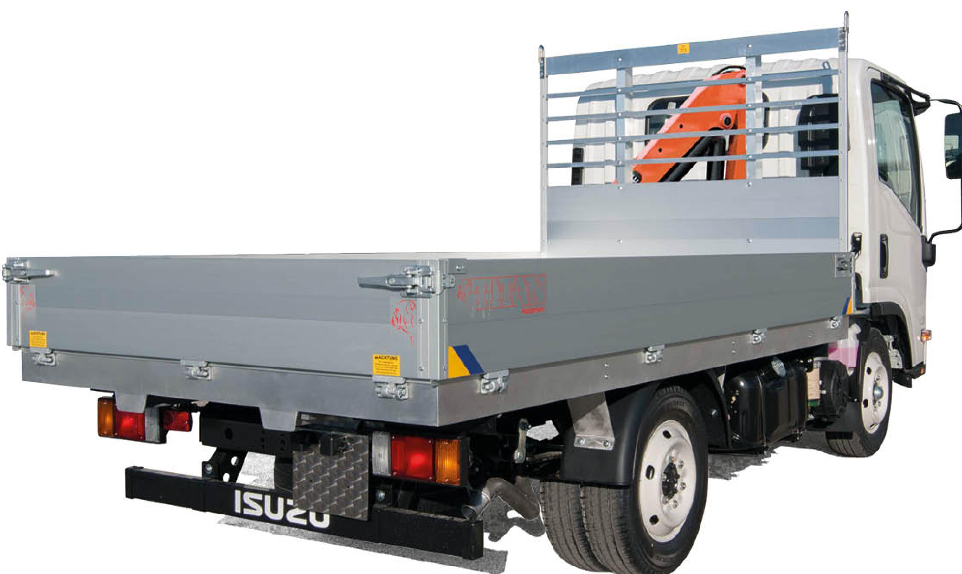
Ladeflächenstruktur aus glatten Aluminiumlamellen aus 30 mm
