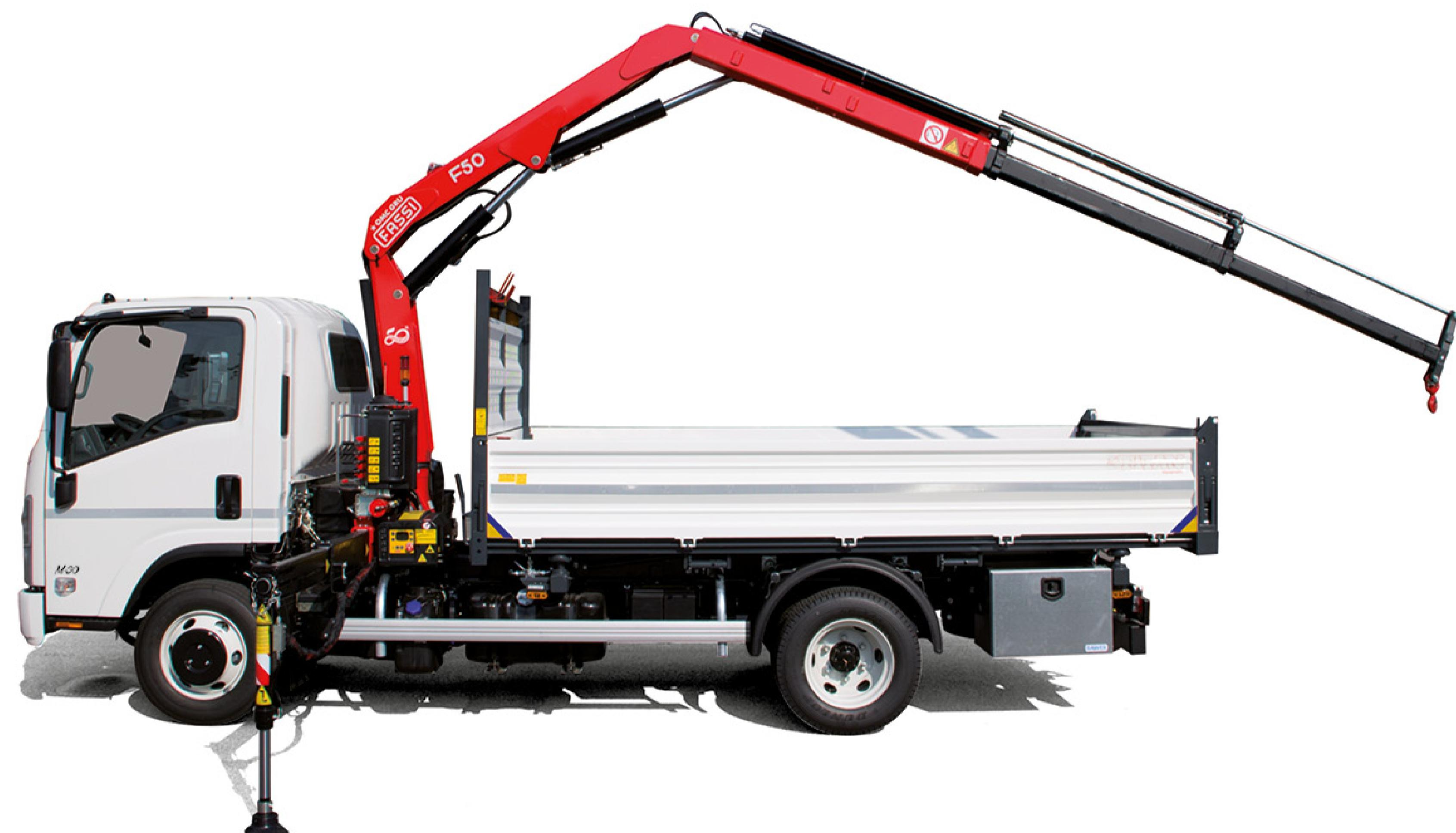
Structure du plancher de chargement en acier S355JR ép. 4 mm
