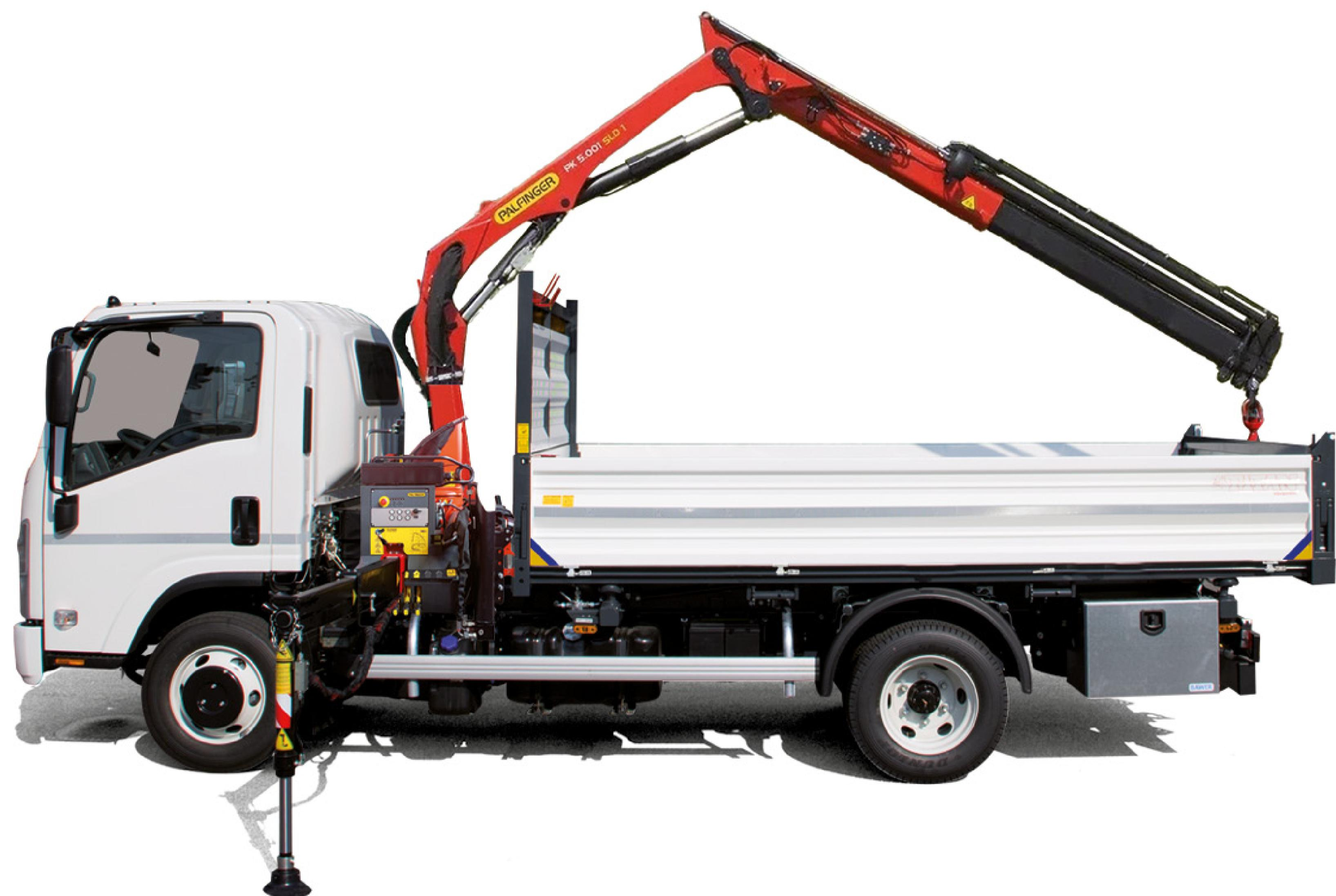
Structure du plancher de chargement en acier S355JR ép. 4 mm
