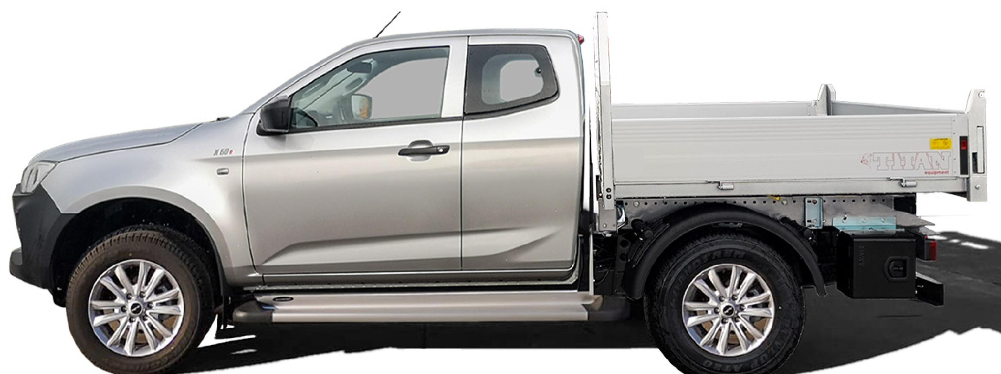
Ladebodenaufbau aus 4 mm starkem Einzel Blech Aluminium
